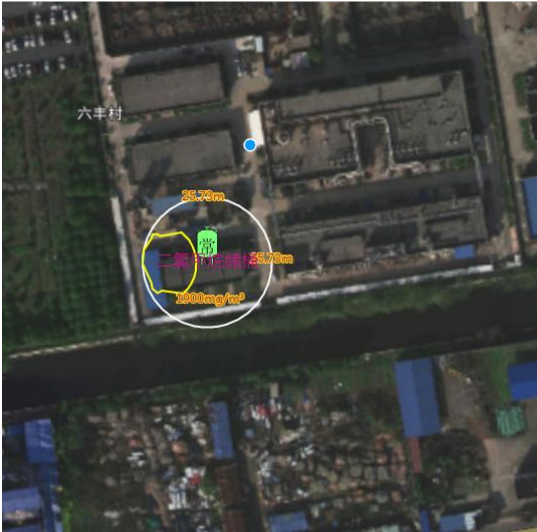
图 6.7.5-2 最不利气象条件二氯甲烷达到大气毒性终点浓度的最大影响范围图
