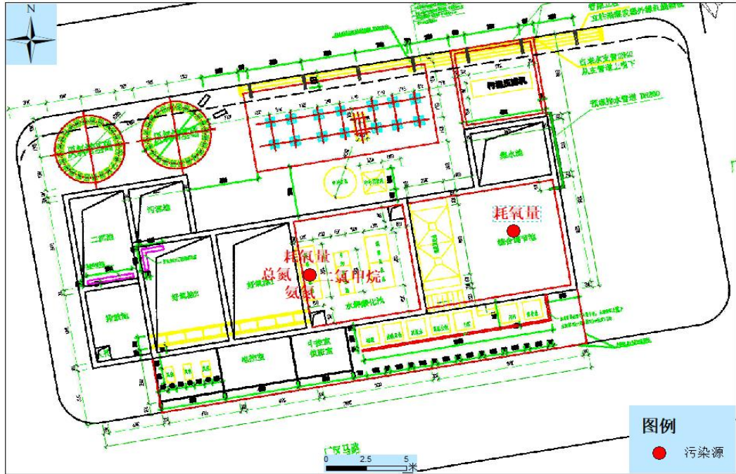
图 6.5.7-9 污水处理站平面布置及污染源位置图
